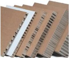
Zwischen den zwei äusseren Kartonlagen befindet sich jeweils eine Schicht Karton mit Bienenwabenstruktur. Auch hier ermöglicht die Struktur, Material und Gewicht zu sparen, aber trotzdem eine hohe Stabilität zu erreichen. Solches Material wird zum Beispiel bei Verpackungen eingesetzt, die stabil sein müssen.
