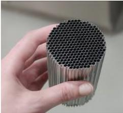
Dieser Dämpfer soll in der Raumfahrt bei der Landung eingesetzt werden. Die Honigwabenstruktur trägt dazu bei, Material und somit Gewicht zu sparen, da herkömmliche Dämpfer zu schwer sind für die Raumfahrt.
