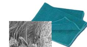
Dieses Wischtuch ist noch ein Prototyp. Die Struktur des Tuchs orientiert sich an den Härchen der Hinterbeine der Ölbiene. Diese Biene kann Öl transportieren, da dieses an den verzweigten Haaren hängen bleibt. Dank der speziellen Anordnung und Struktur dieser Haare tropft das Öl nicht heraus und die Haare verkleben auch nicht durch das Öl.
